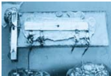
Рис. 1. Интегральная микросхема, созданная Дж. Килби
